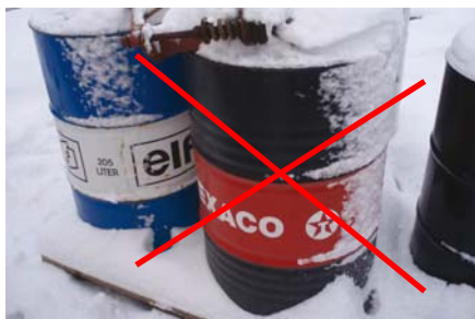
Undgå ubeskyttede oplag af farligt affald, råvarer og produkter. Undgå manglende sikring mod regn og sne
