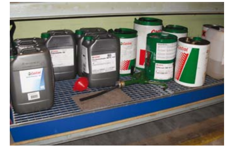
Råvareroplæg stillet på reol med kar til opsamling af evt. spild og lægager
